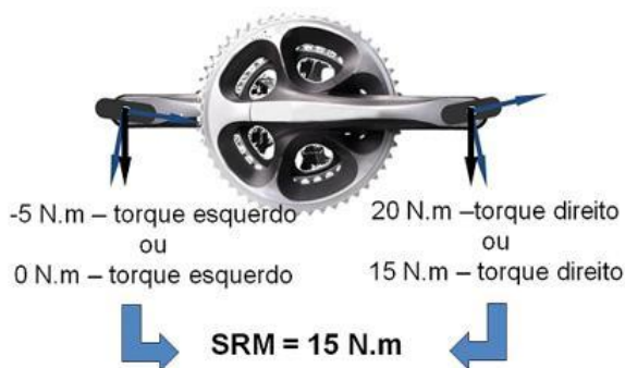
Figura 1. Exemplo ilustrativo do erro de medida no torque resultante mensurado pelo sistema da SRM®.
